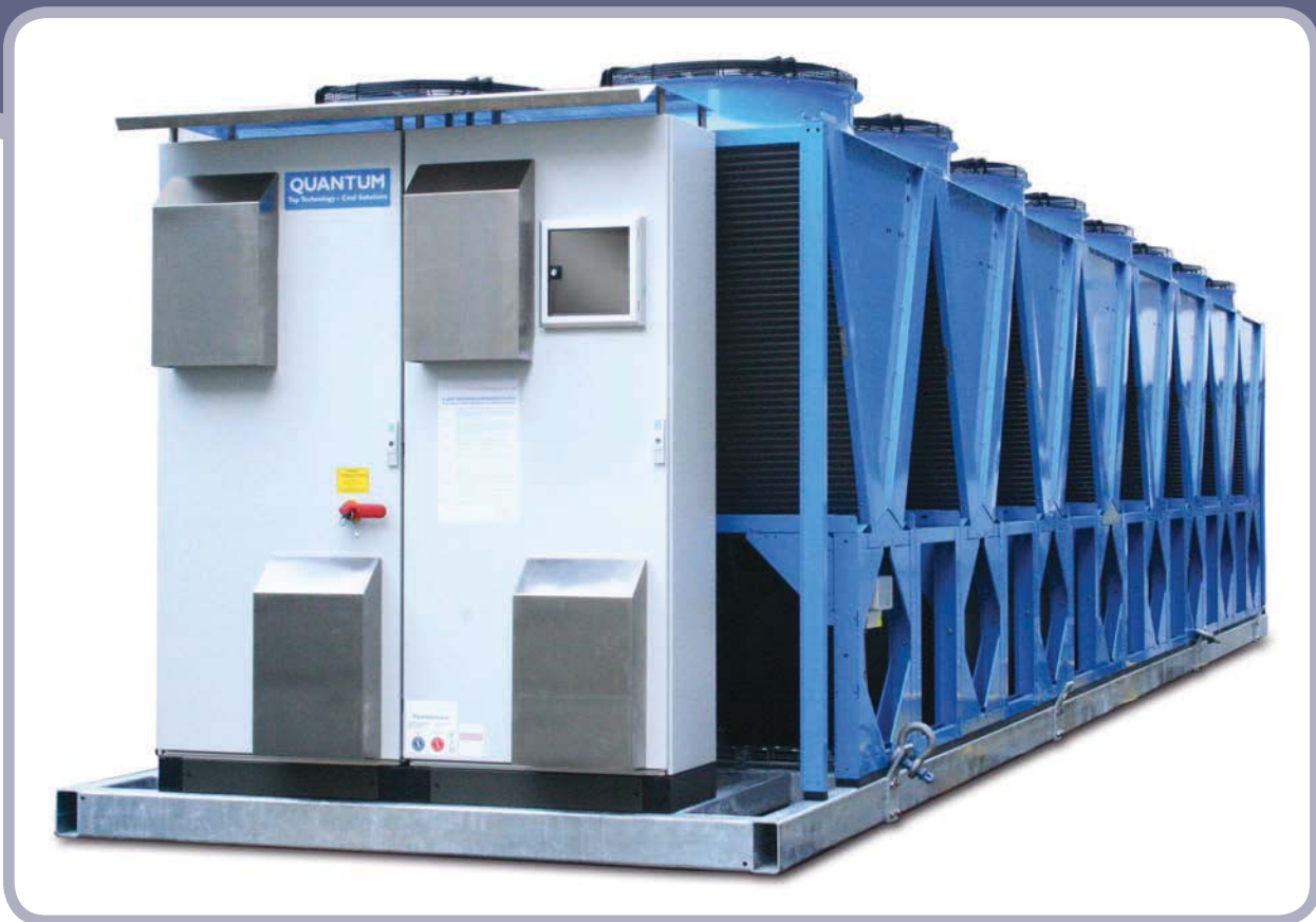
Illustration 2: QUANTUM aéroréfrigéré à 16 ventilateurs, puissance frigorifique nominale jusqu'à 1.100 kW
